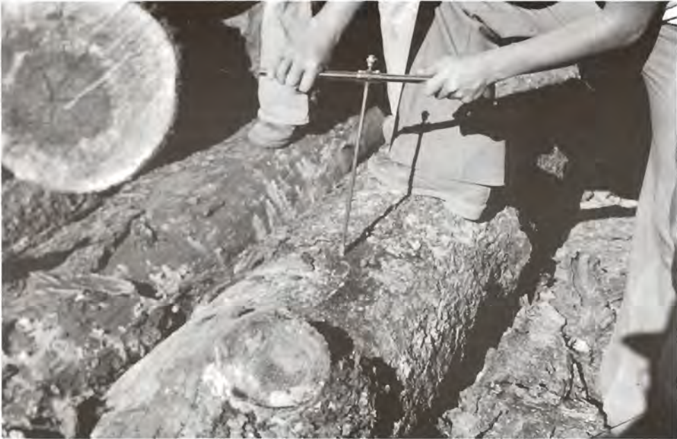
Figura 2. Extracción de muestras con el taladro de Pressler.
