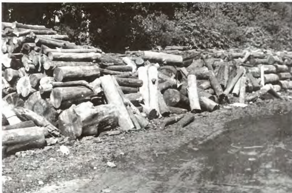
Figura 9. Cuando la madera en rollo no es transportada a tiempo a los aserraderos, es contaminada por el hongo. Nótese el mal estado de las trozas.
