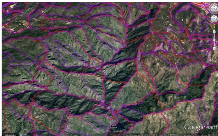
Figura 7. Superposición de las capas de rodales generadas a partir de la variable exposición sobre una imagen de Google earth con técnicas fotogramétricas (color fucsia) y el método semiautomatizado de análisis geomorfométrico de superficies del MDE del Inegi (color rojo).
