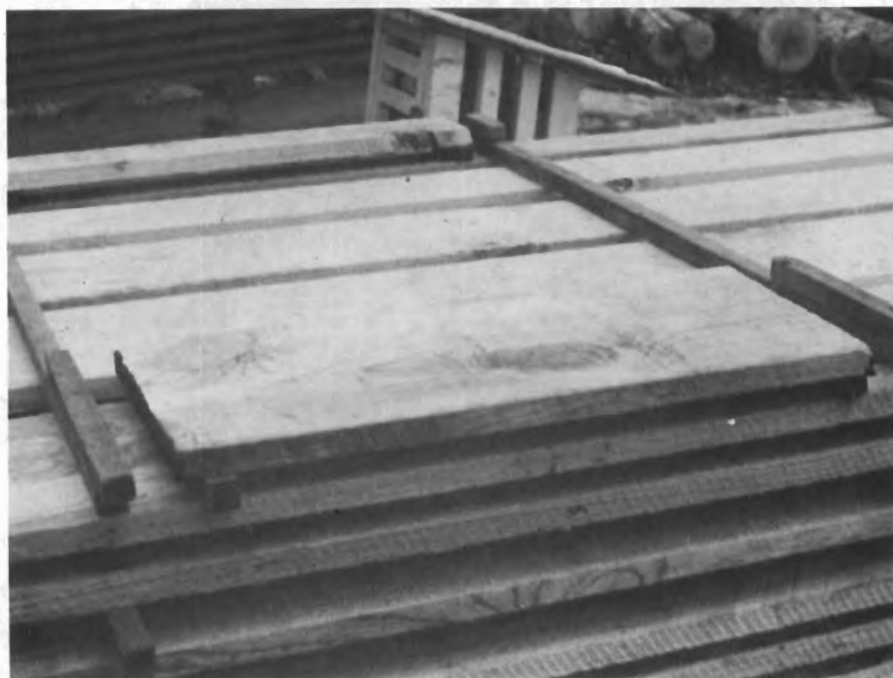
Figuras 3 y 4. Techado de las pilas.
