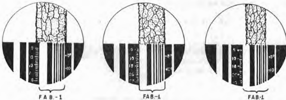
Figura No. 4. Elección de los árboles-muestra en el sitio; a) cuando éste es más grande, b) cuando es más chico y c) tangente a la bisección con la banda FAB 1 .
