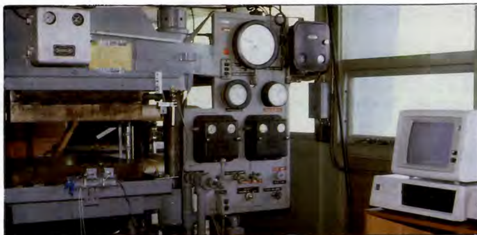
Figura N°. 4. Integración del equipo utilizado durante el prensado de triplay.
