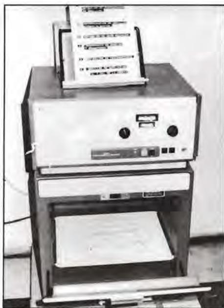
Fig. 1. Sistema de rayos X, Faxitron (Hewlett Pacard de voltaje entre 10-110 kv y corriente constante entre el cátodo de 3 mA. Este sistema está instalado en el Laboratorio de Semillas del Instituto Nacional de Investigaciones Forestales, en Coyoacán, D.F.
